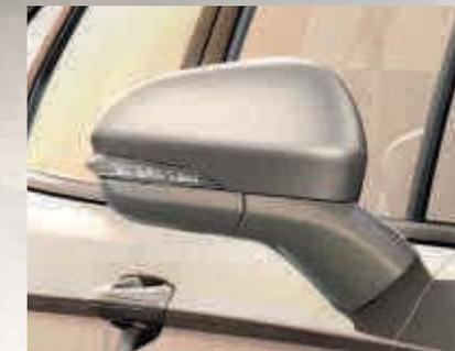
Retrovisori elettrici in tinta scaldati con luci di cortesia e ripiegabili elettricamente (Di serie)
