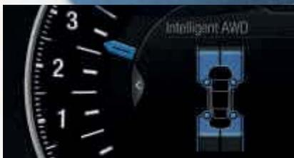
Un display sul quadro strumenti visualizza la ripartizione della potenza sulle quattro ruote. (standard sui modelli AWD)
